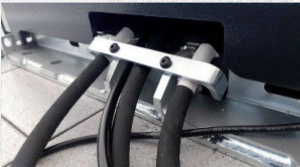
A tale scopo, qualora si rendesse necessaria la sostituzione delle tubazioni idrauliche per usura precoce, si consiglia l'installazione del suddetto supporto, laddove fosse assente, nei modelli di sollevatore di seguito riportati:
